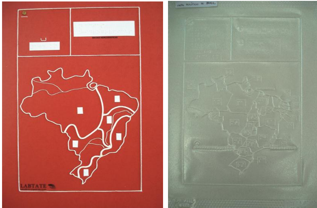
Figura 3 – Matriz para produzir o acetato e acetato através da máquina Thermoform no LabTATE. Fonte: Site LabTATE 3 .
